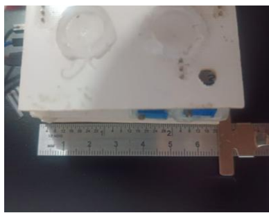
Figura 3. 41: Medidas de la primera versión del sensor sEMG fabricado en placa de cobre.
