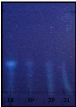
Figura 96. Fase reversa eluida en una proporción 7-3 H 2 O-acetonitrilo. Luz UV onda larga.
