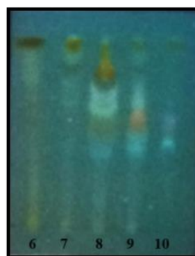
Figura 13. Fase normal eluida en una proporción 9-1 n -hexano-AcOEt. Luz UV onda larga
