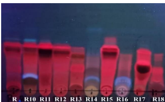
Figura 50. Fase normal eluida en una proporción 7-3 n -hexano-AcOEt. Luz UV onda larga
