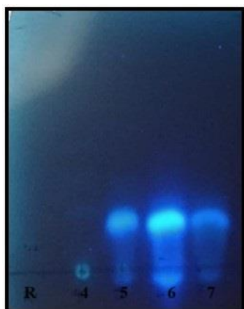
Figura 57. Fase reversa eluida en una proporción 8-2 H 2 O-acetonitrilo. Luz UV onda larga.
