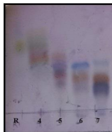
Figura 58. Fase reversa eluida en una proporción 8-2 H 2 O-acetonitrilo. Revelada con 4-hidroxibenzaldehído.
