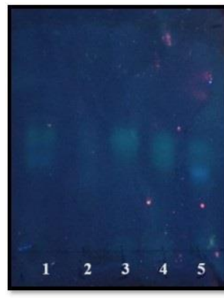
Figura 85. Fase reversa eluida en una proporción 7-3 H 2 O-acetonitrilo. Revelada con sulfato cérico.
