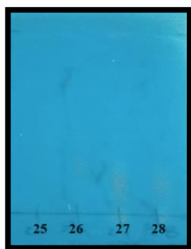
Figura 68. Fase reversa eluida en una proporción 3-7 H 2 O-acetonitrilo. Luz UV onda corta
