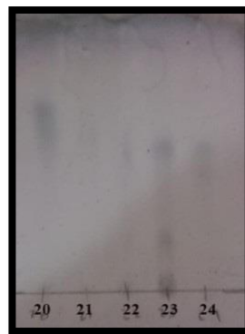
Figura 67. Fase reversa eluida en una proporción 3-7 H 2 O-acetonitrilo. Revelada con 4-hidroxibenzaldehído.
