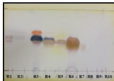
Figura 100. Fase reversa eluida en una proporción 7-3 H 2 O-acetonitrilo. Revelada con sulfato cérico.
