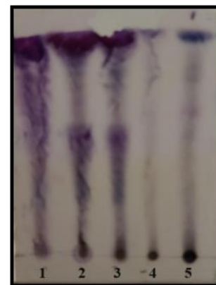
Figura 10. Fase normal eluida en una proporción 9-1 n -hexano-AcOEt. Luz UV onda larga.
