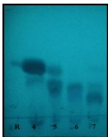
Figura 56. Fase reversa eluida en una proporción 8-2 H 2 O-acetonitrilo Luz UV onda corta.
