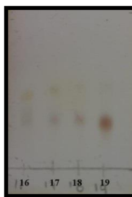
Figura 64. Fase reversa eluida en una proporción 8-2 H 2 O-acetonitrilo. Revelada con sulfato cérico.
