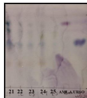
Figura 26. Fase normal eluida en una proporción 7-3 n -hexano-AcOEt. Revelada con 4-hidroxibenzaldehído.
