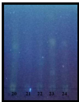
Figura 66. Fase reversa eluida en una proporción 3-7 H 2 O-acetonitrilo. Luz UV onda larga.
