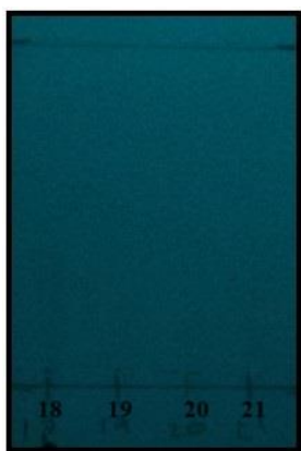
Figura 95. Fase reversa eluida en una proporción 7-3 H 2 O-acetonitrilo Luz UV onda corta.
