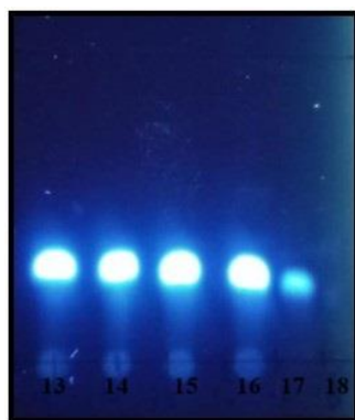
Figura 93. Fase reversa eluida en una proporción 7-3 \text{H}_2\text{O} -acetonitrilo. Luz UV onda larga.
