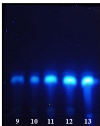
Figura 90. Fase reversa eluida en una proporción 7-3 \text{H}_2\text{O} -acetonitrilo. Luz UV onda larga
