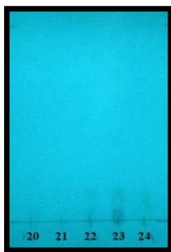
Figura 65. Fase reversa eluida en una proporción 3-7 H 2 O-acetonitrilo Luz UV onda corta.
