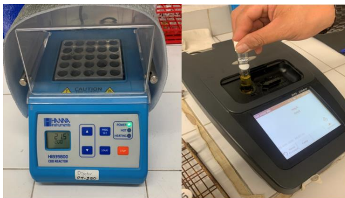
Figura 8 Equipos de análisis de la calidad del agua. Nota: imagen de los equipos empleados durante el análisis de la composición intrínseca de las cualidades y la calidad del agua, en la izquierda se encuentra el biodigestor de marca Hanna, en la derecha se observa un espectrofotómetro de marca Hach (fotografías de autoría propia, 2025).
