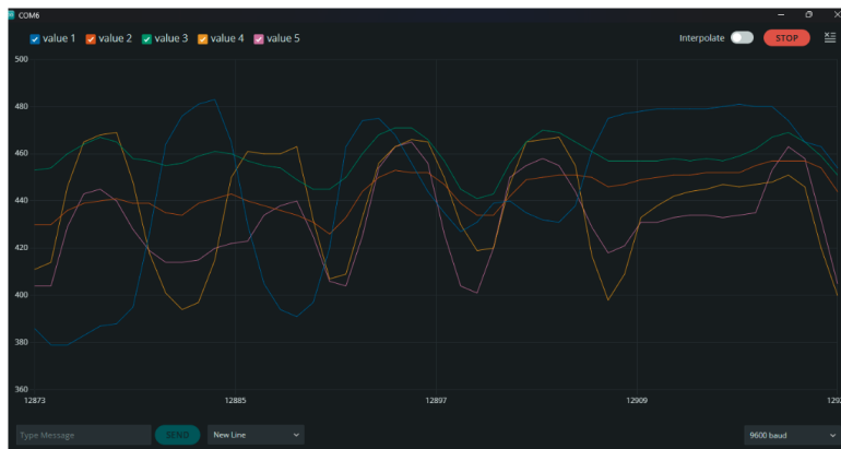
Figura 2.1: Visualización de las señales análogas de los sensores flexibles y el acelerómetro analógico desplegadas en el serial plotter del IDE de Arduino
