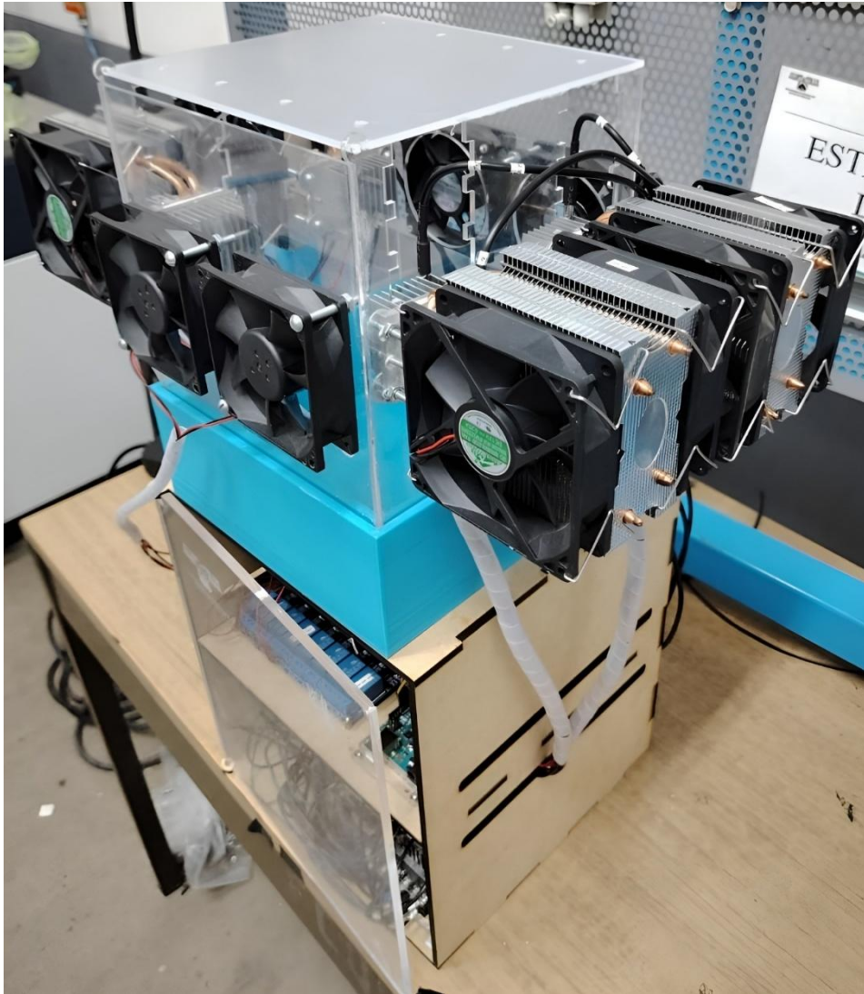
Figura 4.2 Prototipo desarrollado para la obtención de agua mediante la humedad relativa en la atmosfera [14].
