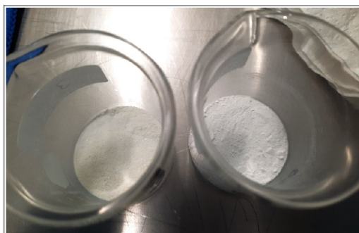
Figura 4: Síntesis de ZrO_2 dopada con Yb posterior al proceso evaporativo donde se obtiene como producto un polvo de color blanco en el fondo de los vasos de precipitados.
