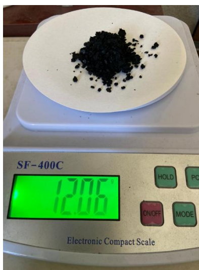
Figura 4.7. Masa negra de cátodo libre de aluminio.
