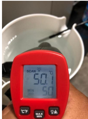
Figura 3.3. Calibración del sensor de temperatura.
