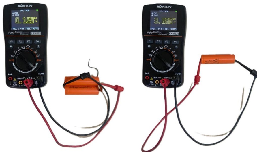
Figura 4.3. Estado de carga de dos pilas que formaban parte de una batería de desecho.
