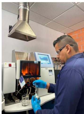
Figura 4.15. Midiendo la concentración de litio por EAA.
