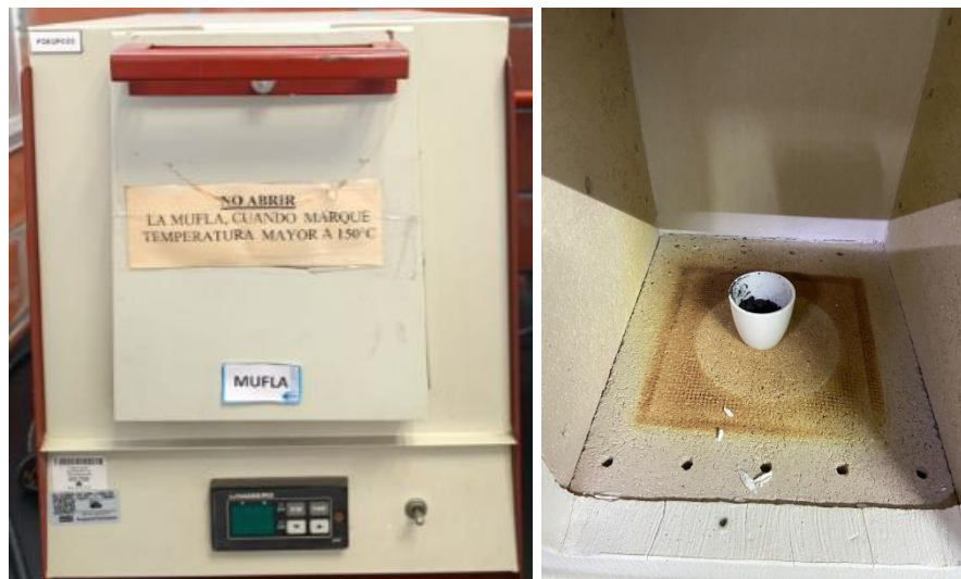
Figura 4.8. Tratamiento térmico de la masa negra de cátodo en mufla.
