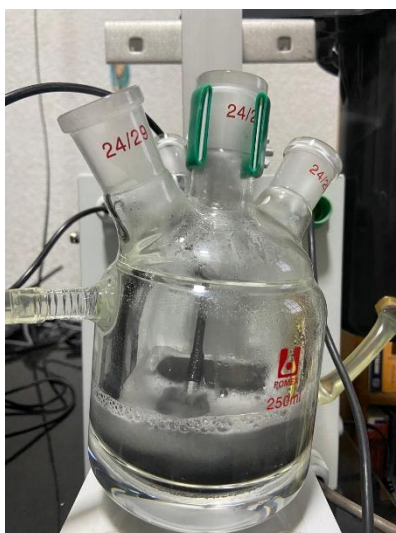
Figura 4.5. Disolución del aluminio con una solución de NaOH .
