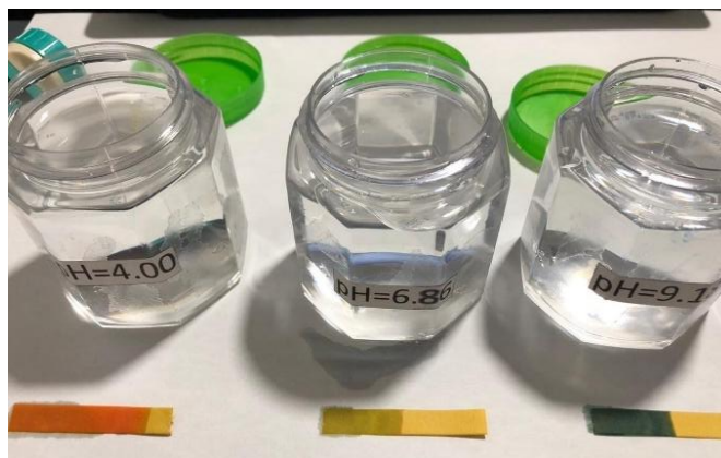
Figura 3.4. Estándares de pH y tiras reactivas usadas en la caracterización del sensor de pH.
