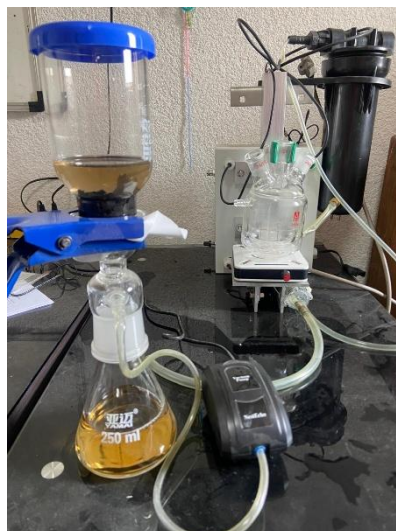
Figura 4.6. Filtrado al vacío del aluminato de sodio.
