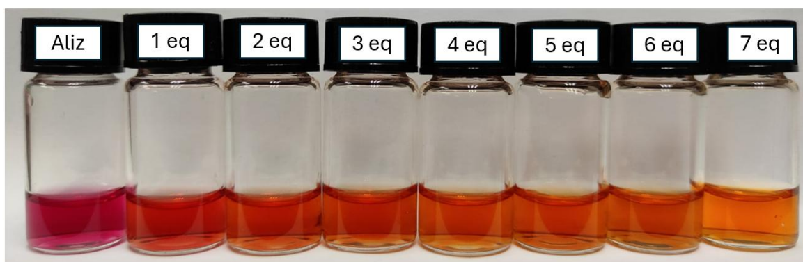
Figura 23. Fotografía que representa la formación del boronato, se muestra el cambio de color derivado de la interacción de rojo de alizarina tras la adición de 1 a 7 equivalentes del ácido 4-fluorfenilborónico en solución amortiguadora a pH 7.4, a temperatura ambiente.
