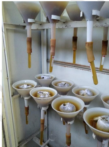
Ilustración 9 Técnica del embudo de Baermann
