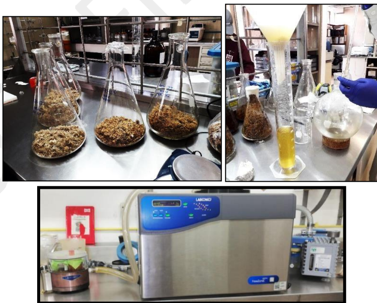
Ilustración 4 Obtención de los extractos hidroalcohólicos de las diferentes mezclas de sustrato degradado de P. ostreatus
