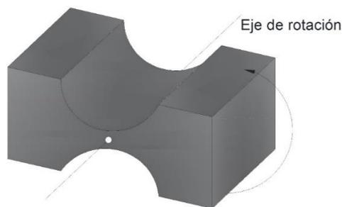
Figura 2.8 Ejemplo de unión flexible tipo circular que rota en un eje. Elaboración propia.
