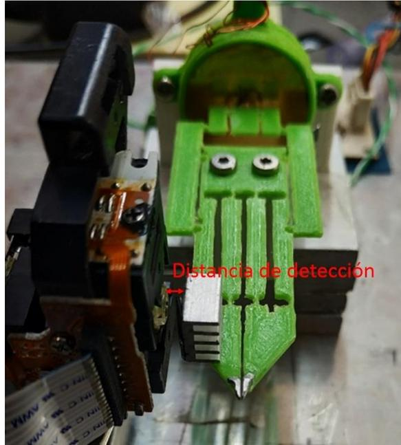
Figura 4.16 Acercamiento de sistema de medición de desplazamiento en las mandíbulas de la micropinza. Elaboración propia.
