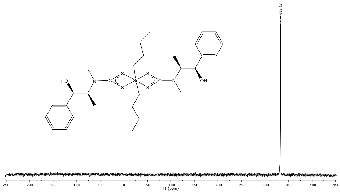
Espectro de RMN de ^{119}\text{Sn} en \text{CDCl}_3
