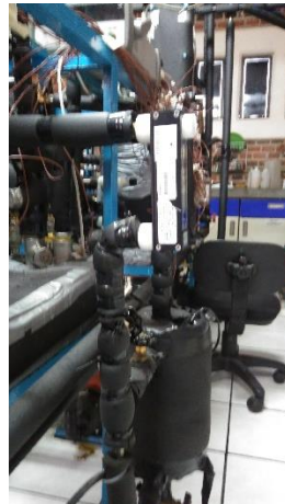
Figura 4.6.- Reemplazo de los flujómetros analógicos por los digitales
