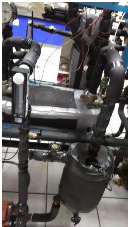
Figura 4.6.- Reemplazo de los flujómetros analógicos por los digitales
