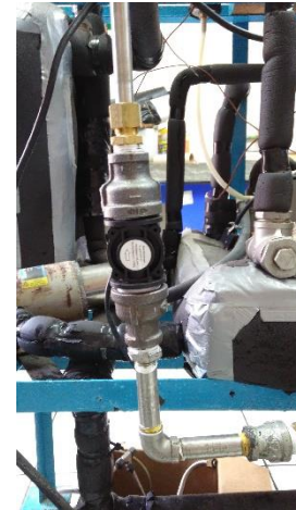
Figura 4.6.- Reemplazo de los flujómetros analógicos por los digitales
