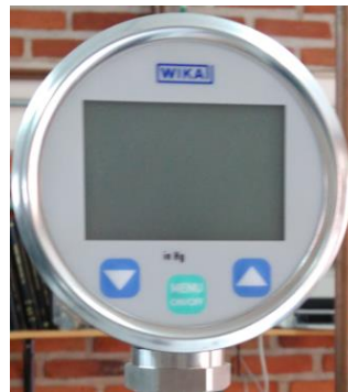
Figura 3.12.- Manovacuómetros utilizados en el DSHT
