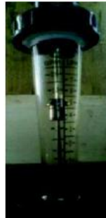
Figura 3.7.- Flujómetro con escala 1 – 7 l/min
