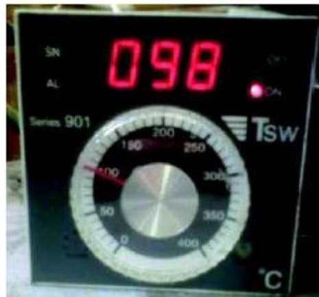
Figura 3.15.- Pirómetro utilizado para el censado y regulación de temperatura
