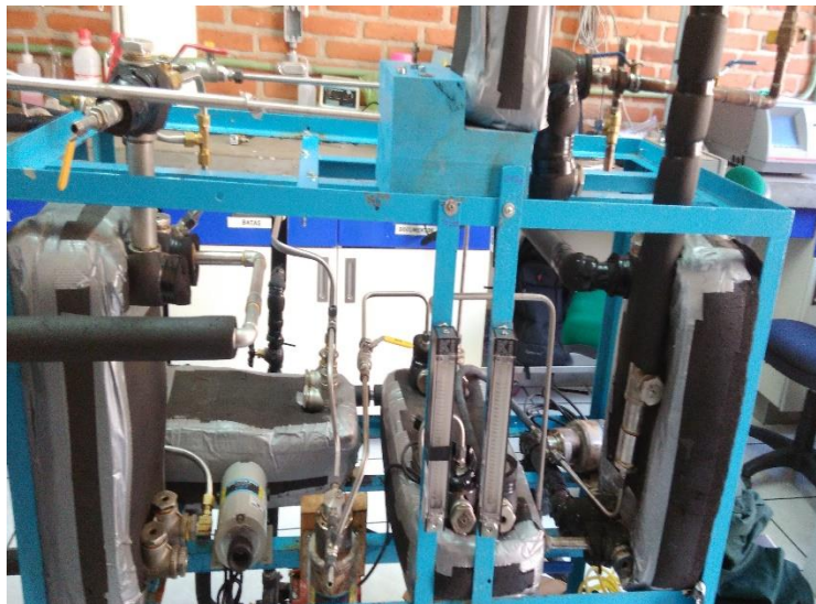
Figura 5.4.- Armado del DHST con el cambio de posición en economizar e intercambiador de calor útil
