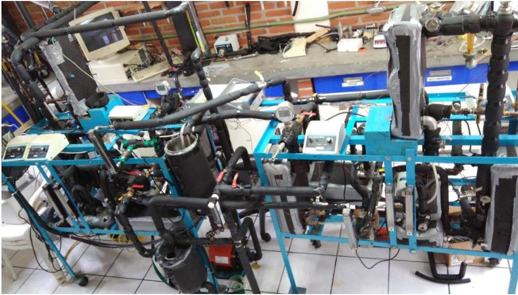
Figura 5.5.- Transformador térmico de doble etapa
