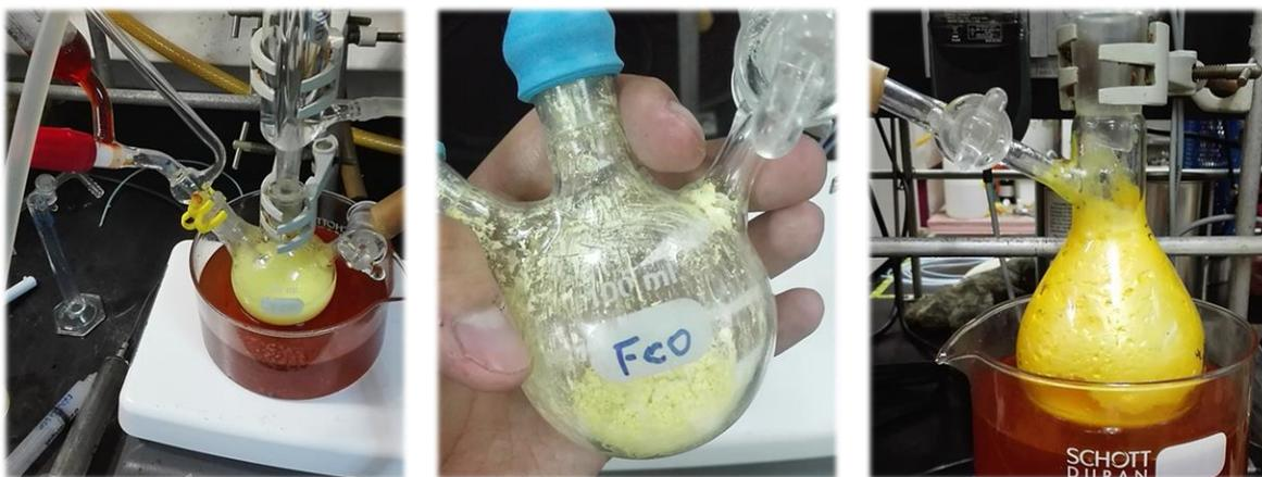
**Figura SE.2.** (a) *A la izquierda* – Adición del precursor de Pt(II),  $K_2[PtCl_4]$  en  $H_2O$ , a una disolución en reflujo de  $PPh_3$  en EtOH. (b) *En medio* – obtención del complejo tetrakis(trifenilfosfina) de platino(0),  $[Pt(PPh_3)_4]$  de coloración amarillo pálido. (c) *A la derecha* – formación del complejo  $[Pt(PPh_3)_3]$  de color amarillo intenso, tras redisolución y filtración en tolueno y posterior reflujo en EtOH por 3 horas.
