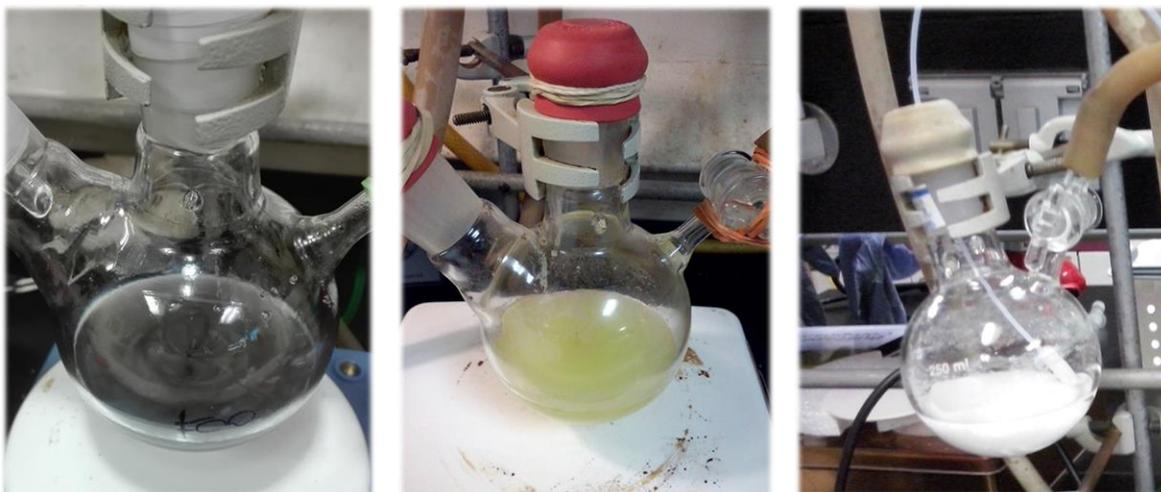
**Figura SE.1.** (a) *A la izquierda* – Coloración del compuesto organomagnesio, tras adición completa de *orto*-bromotolueno a una suspensión de Mg en THF a reflujo. (b) *En medio* – Coloración adquirida tras la adición de clorodifenilfosfina a la disolución del organomagnesio a 0°C. (c) *A la derecha* – Obtención del compuesto difenil(*o*-tolil)fosfina como un sólido blanco.
