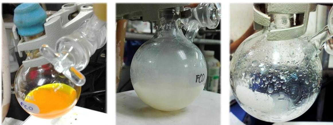
**Figura SE.4.** (a) *A la izquierda* – Coloración de la disolución del organolitio PL2 tras una hora de reacción después de la adición de *n*-BuLi. (b) *En medio* – Coloración adquirida tras adición del correspondiente silano, con formación de HCl gas. (c) *A la derecha* – apariencia de los ligantes tras purificación y evaporación de disolvente.
