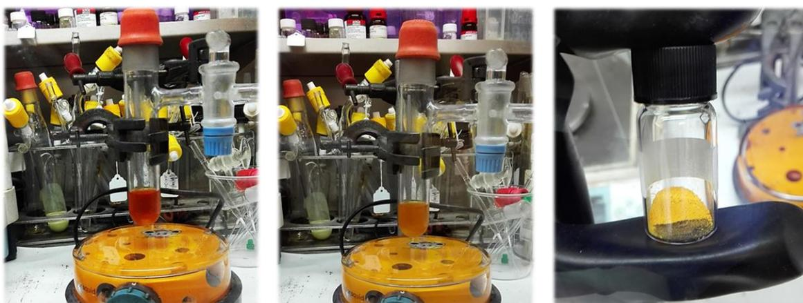
**Figura SE.5.** (a) A la izquierda – Coloración adquirida tras la adición de PEt<sub>3</sub> a la disolución de [Ni(COD)]<sub>2</sub> en hexano tras 10 minutos de reacción. (b) *En medio* – formación del complejo *trans*-[NiBr(PEt<sub>3</sub>)<sub>2</sub>(*p*-C<sub>6</sub>H<sub>4</sub>NMe<sub>2</sub>)], tras 24 horas de reacción. (c) A la derecha – complejo *trans*-[NiBr(PEt<sub>3</sub>)<sub>2</sub>(*p*-C<sub>6</sub>H<sub>4</sub>NMe<sub>2</sub>)] purificado en estado sólido.
