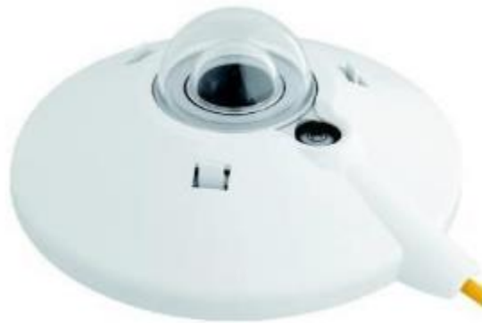
Figura 31. Piranómetro utilizado para la medición de radiación solar. (Gonzalo Navia, 2015)
