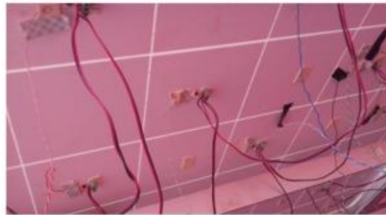
Figura 29. Ejemplo de la posición de los sensores de temperatura. (Rivera, 2014)
