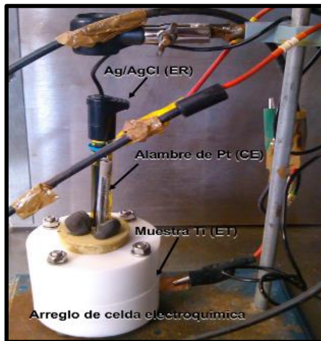
Figura 17 Celda electroquímica para las pruebas electroquímicas (CP y Rpl).
