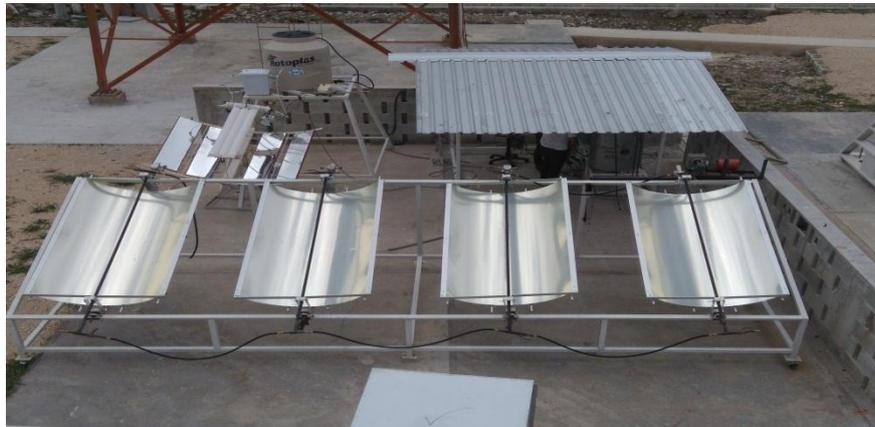
**Figura 4.4:** Construcción final del sistema de los CCPs.
