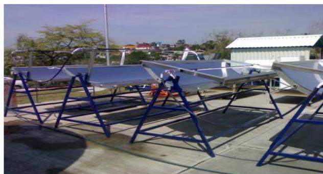
**Figura 2.14:** Arreglo de colectores, del lado izquierdo se aprecian los CCP- 45 y del lado derecho los CCP-90 (Venegas, 2013)
