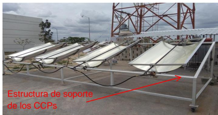
**Figura 4.5:** Diseño final de la estructura de soporte con los CCP.
