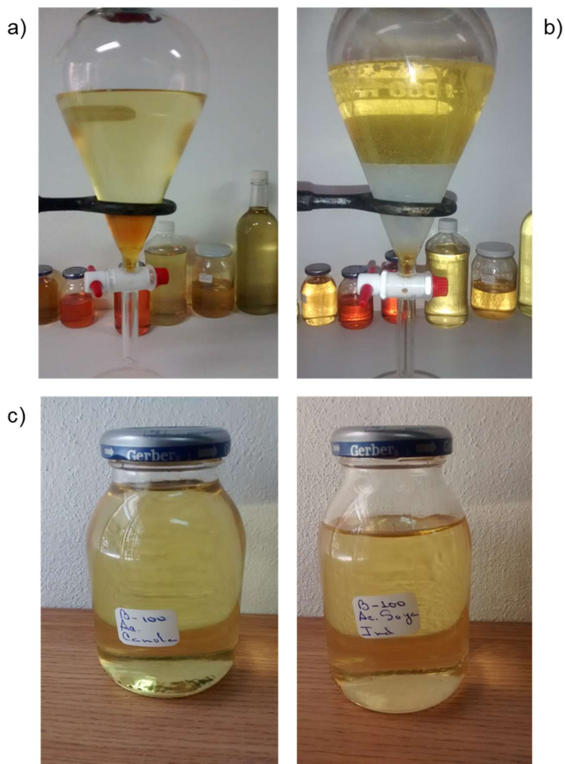
Figura 3.1 Imágenes de las etapas de producción de biodiesel a escala de laboratorio; a) separación de fases, b) etapas de lavado del biocombustible y c) producto final resultante.
