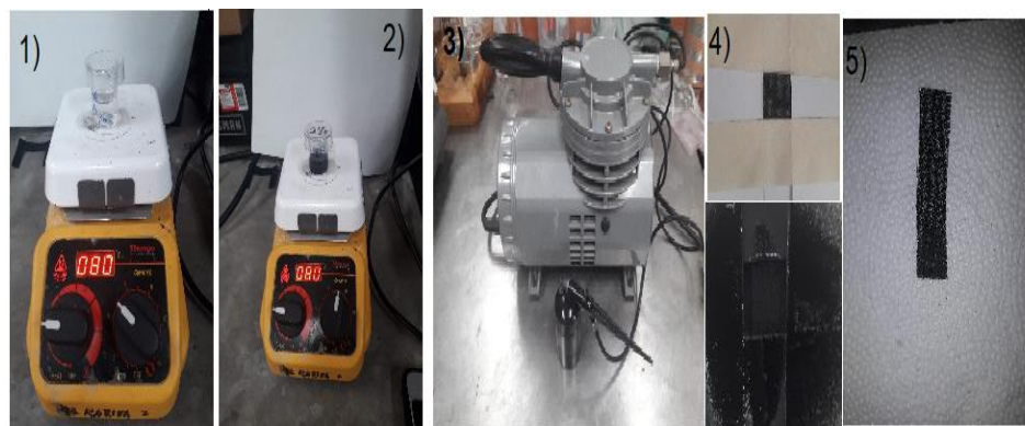
Figura 3.5. Procedimiento de elaboración de electrodos delgados.1.-Solución de PVA al 1%, 2.- dispersión del material activo en la solución 3.- aerógrafo, 4.- depósito en la tela de carbón 1\text{ cm}^2 , 5.- Electrodo terminado.
