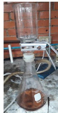
Se filtra a vacío con una membrana de nylon Millipore y se lava
