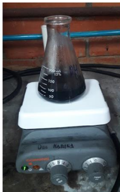
Se incorpora el precursor correspondiente, 3 gotas de HCl y 50 ml de agua DI.
