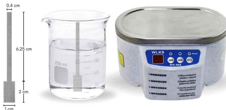
Figura 5. Dimensiones y proceso de limpieza del ánodo.
