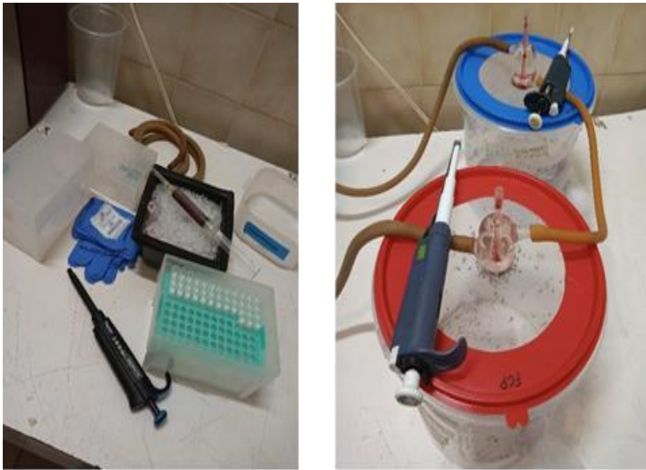
Figura 14. Material utilizado para la alimentación con sangre infectada con DENV2 y sangre sin infectar (mock). Se empleó un recirculador de agua a 37°C, alimentadores artificiales de vidrio, membranas de parafilm, guantes, pipeta, puntas nuevas con filtro, sangre de conejo fresca (3ml) y el stock viral de DENV2 (1 ml).
