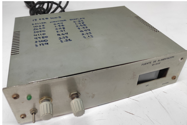
Figura 3.6: Fuente de poder que provee la diferencia de potencial de colección entre electrodos ( \pm 5 kV). En este caso, se muestra la de polaridad positiva. Hace el barrido automatizado en el intervalo deseado a través de un voltaje de control externo.
