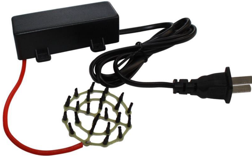
Figura 3.4: Se muestra el ionizador DF-FA8000D original capaz de proveer 1 \times 10^8 iones negativos según declara el fabricante (cuando conectada a un tomacorriente). Veremos en el capítulo Resultados 4 que después de ser modificado, producirá alrededor de cinco órdenes de magnitud más.
