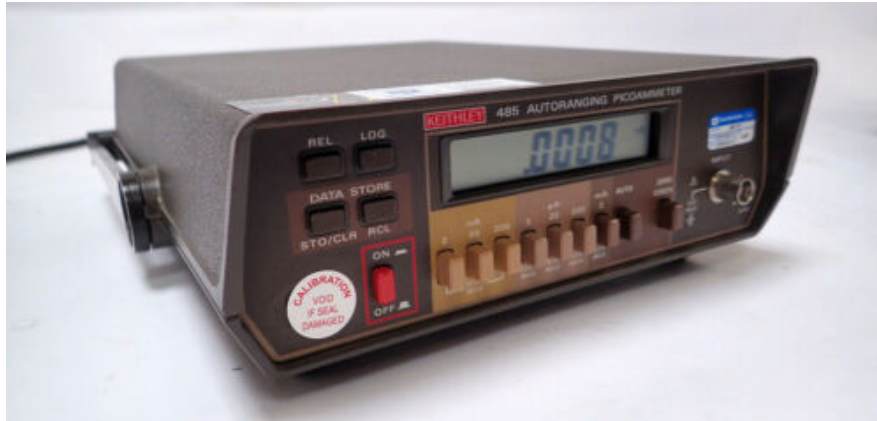
Figura 3.7: El picoamperímetro Keithley 485, un instrumento de medición de corrientes muy bajas, esencial para detectar corrientes en el rango de 100 fA (0.1 pA).
