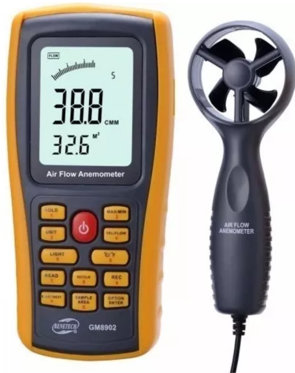
(a) Anemómetro GM8902 se utilizó para medir la velocidad del viento, con la cual es posible calcular el flujo.
