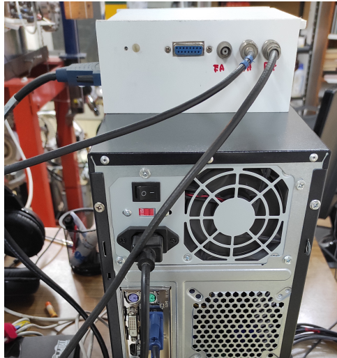
Figura 3.10: Se presenta la parte posterior del ordenador que tiene instalado el LabVIEW. Se puede observar a la caja blanca en la parte superior, donde se encuentra el módulo de adquisición de datos DAQ.
