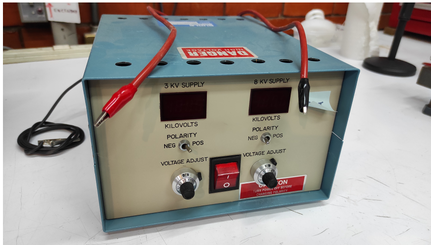
Figura 3.5: Fuente de poder que provee la diferencia de potencial ( \pm 8.4 kV) de alimentación para el cañón de iones. El cable con punta negra es la salida negativa y el rojo, la positiva. El cable enrollado que está por detrás es la conexión a tierra.
