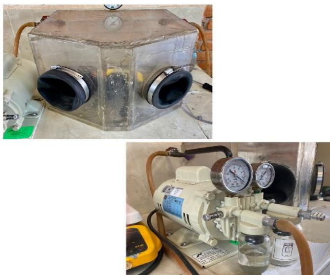
Figura 9: Cámara y bomba de vacío
