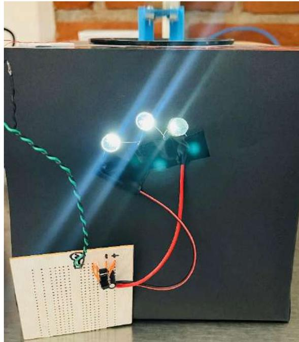
Figura 4.13 Prueba de Dispositivo cosechador encendiendo 3 Leds.
