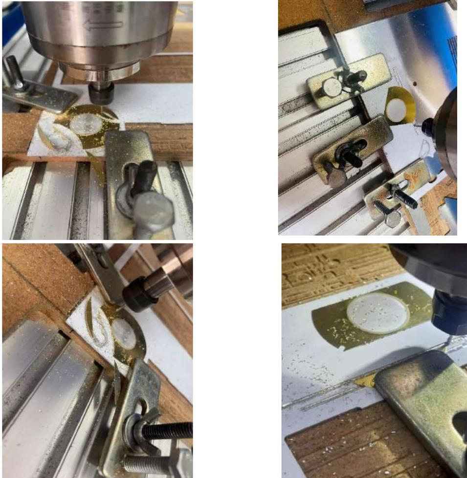
Figura 4.2 Proceso de cortes en CNC.
