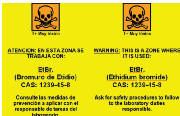
Figura 1. Señalética que debe de tener las áreas de trabajo con BrET.
