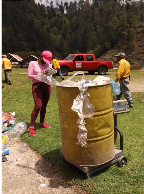
Figura 4. Obtención del peso volumétrico de residuos de acuerdo con lo establecido en la NMX-AA-19-1985
