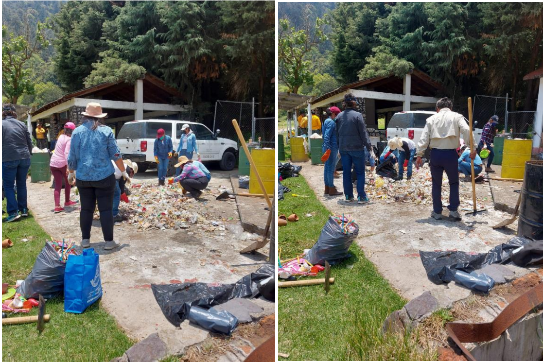
Figura 5. Procedimiento de selección y cuantificación de subproductos como lo establece la NMX-AA-22-1985
