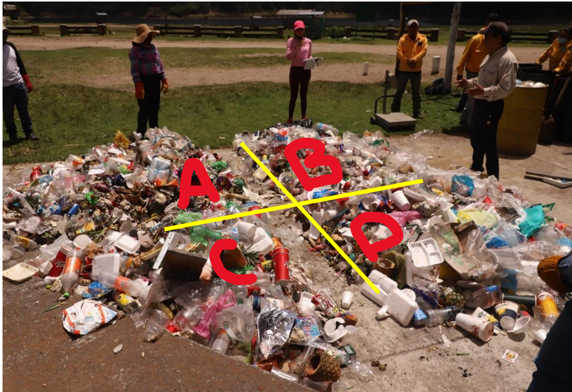
Figura 3. Método de cuarteo como lo marca la NMX-AA-15-1985
