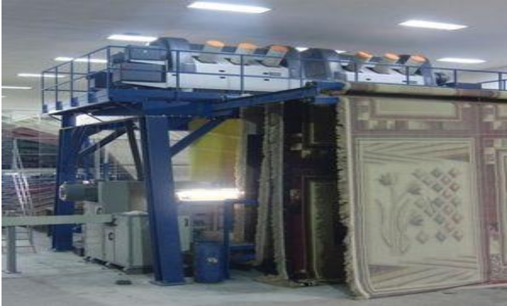
Figura 35. máquina de anudar alfombras. Fuente: ( fibersource.com ).
