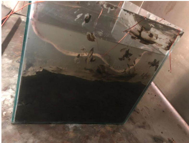
Figura 3.10 Montaje final de la CCMB.
