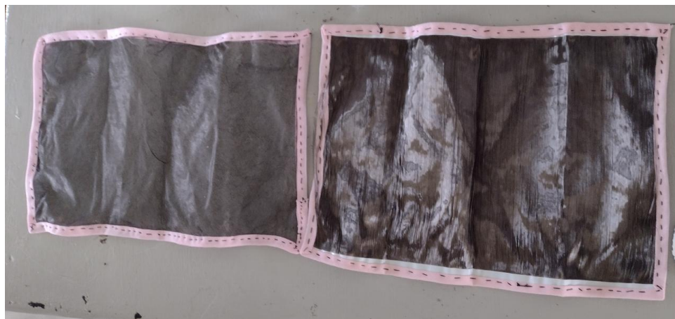
Figura 3.6 Fibra de carbón convencional (izquierda) y fibra de carbón Veil (derecha) con tela de algodón cosida alrededor.
