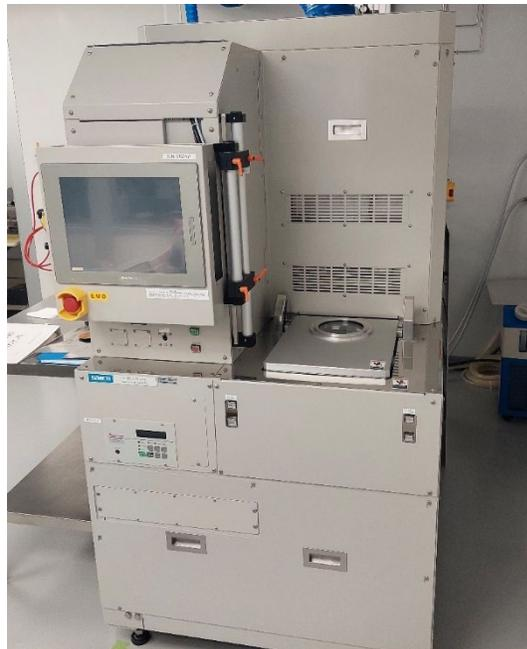
*Figura 5.32. Equipo DRIE. Propiedad del Laboratorio de Microtecnologías de CIDESI.*
