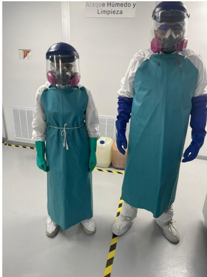
*Figura 5.30. Traje para la manipulación de ácidos. Propiedad del Laboratorio de Microtecnologías de CIDESI.*
