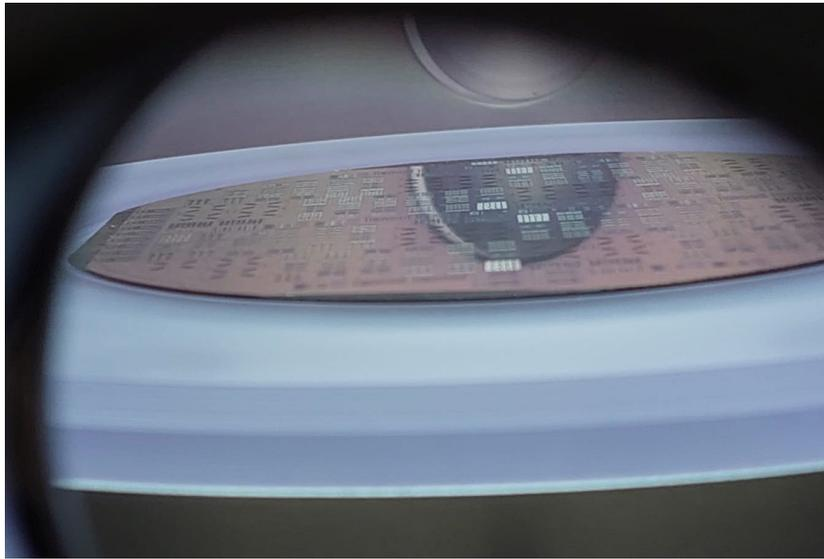
Figura 5.34. Oblea en la cámara de vacío del DRIE en el proceso de grabado.
