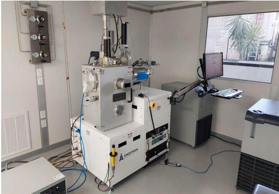
*Figura 5.21. EBE en el cuarto limpio. Propiedad del Laboratorio de Microtecnologías de CIDESI.*
