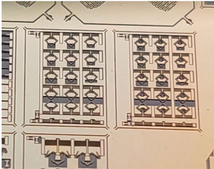
Figura 5.35. Micropinzas después del proceso DRIE.
