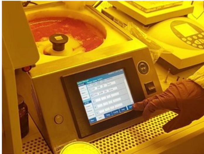
*Figura 5.24. Oblea en la centrifuga. Propiedad del Laboratorio de Microtecnologías de CIDESI.*
