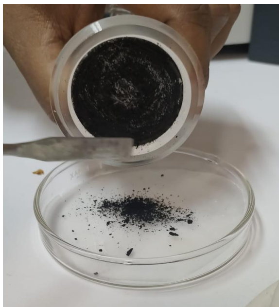
Figura 3.5 Polvo de carbón de ZIF-67 lavado con HCl después de la microfiltración.
