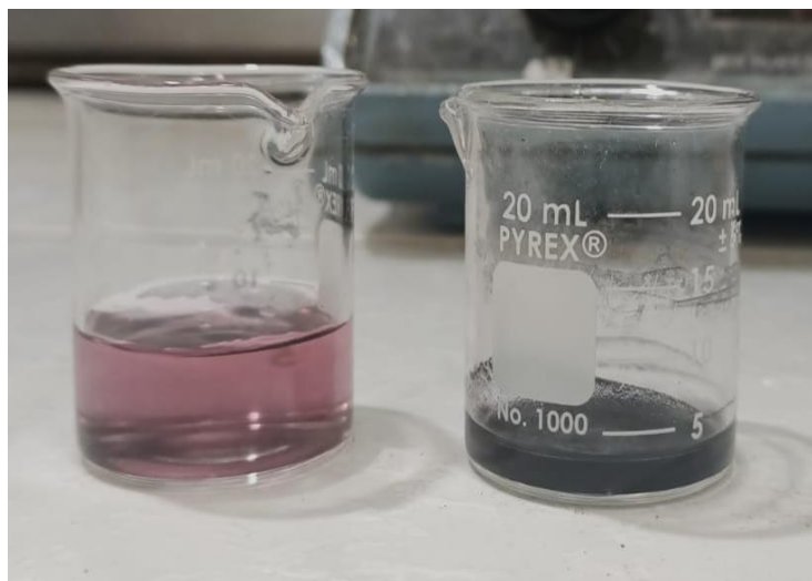
Figura 3.4 Viraje de color del carbón de ZIF-67 al agregarle HCl para la remoción de cobalto.
