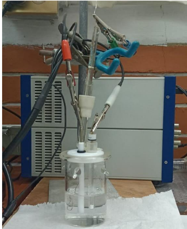
Figura 3.7 instalación de la celda electroquímica con el sistema de tres electrodos.
