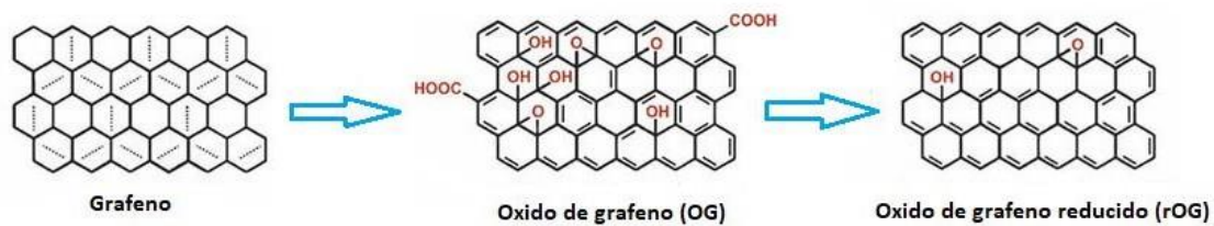
Figura 2.4 Diferencia de enlaces entre el grafeno, óxido de grafeno y óxido de grafeno reducido (nanografi.com , s.f.).
