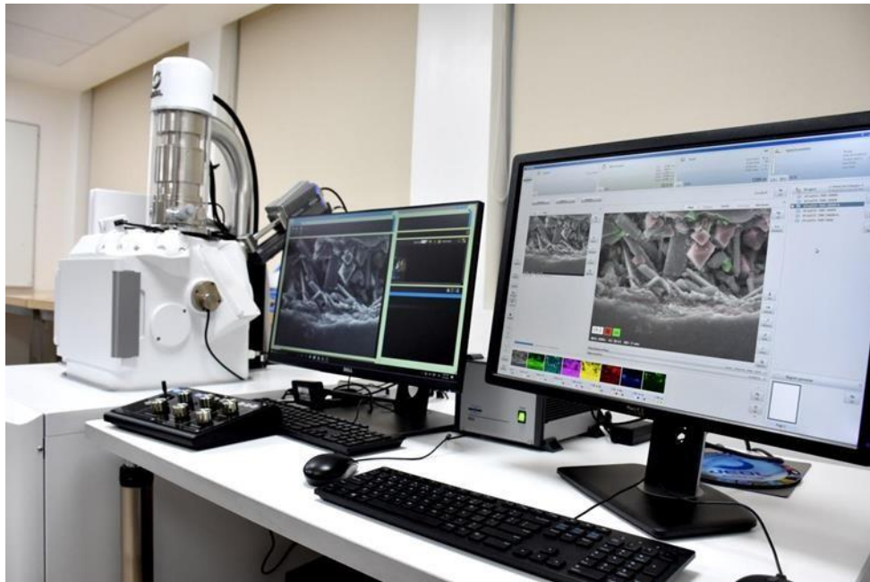
Figura 3.10 Microscopio Electrónico de Barrido Jeol© jsm-it500 durante un mapeo de elementos eds con el detector Bruker© Xflash 6|30.
