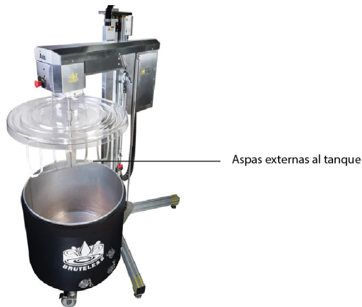
Figura 21. Ejemplo de lavadora con agitación mediante aspas externas (Pure-pressure, 2020)
