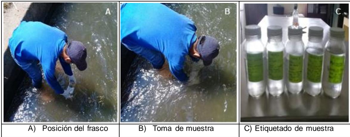
**Figura 2.** Toma, transporte y conservación de la muestra.
