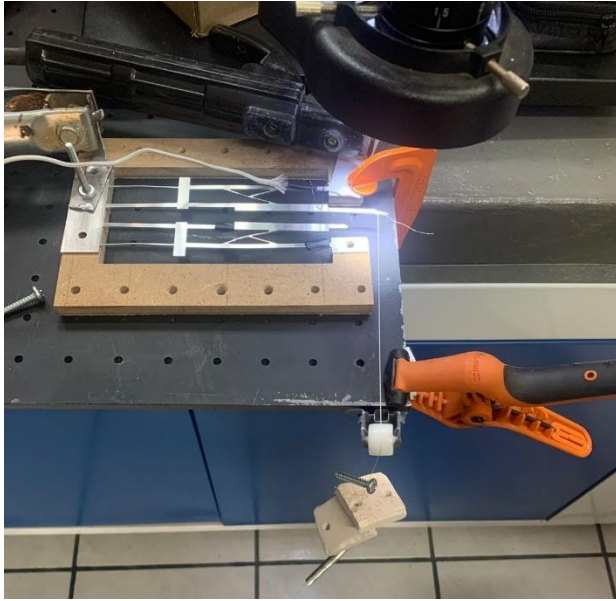
Figura 5. 32 sujeción de polea y micropinza en la base del microscopio, (Elaboración propia).
