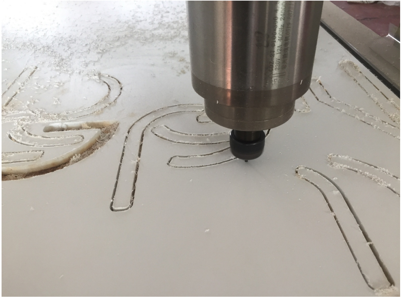
Cortes en lámina de trovicel con Router
