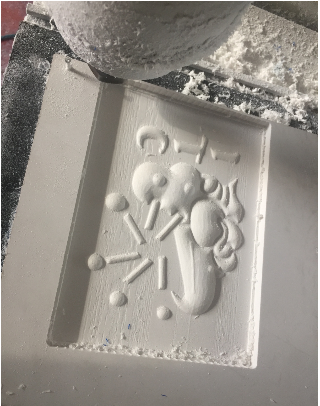
Pieza para molde de caucho hecha en Router CNC
