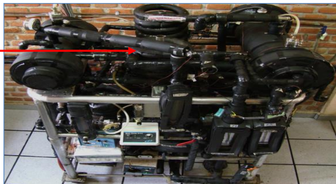
Fig. 2.3. Transformador térmico ubicado en el LITA CIICAp, donde fueron realizadas las pruebas experimentales.
