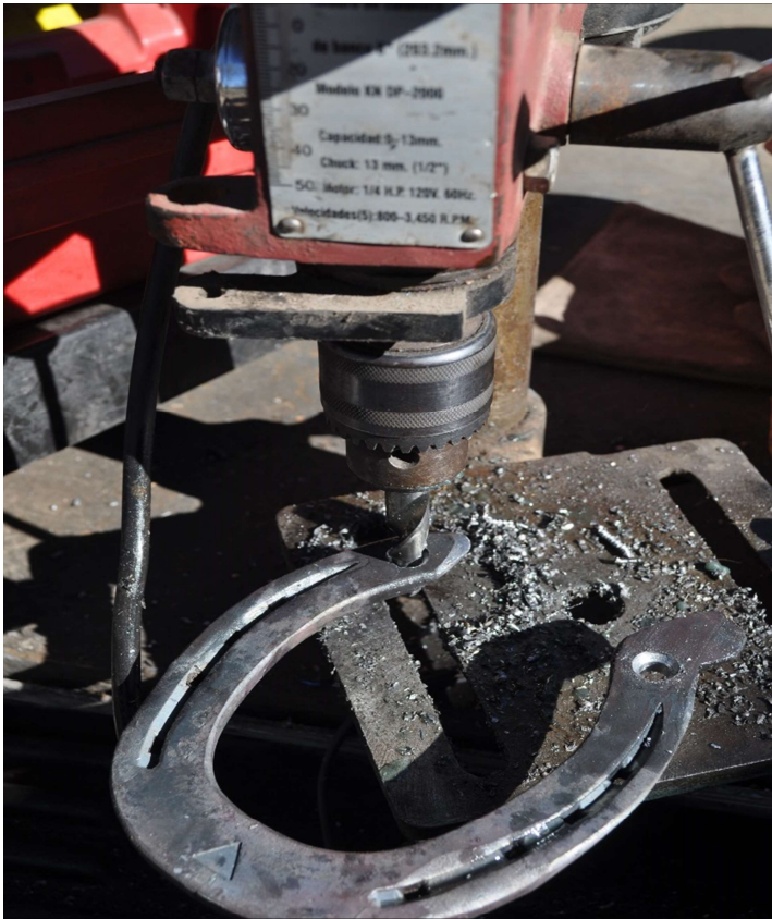
Figura 40. Haciendo hoyos con un taladro
