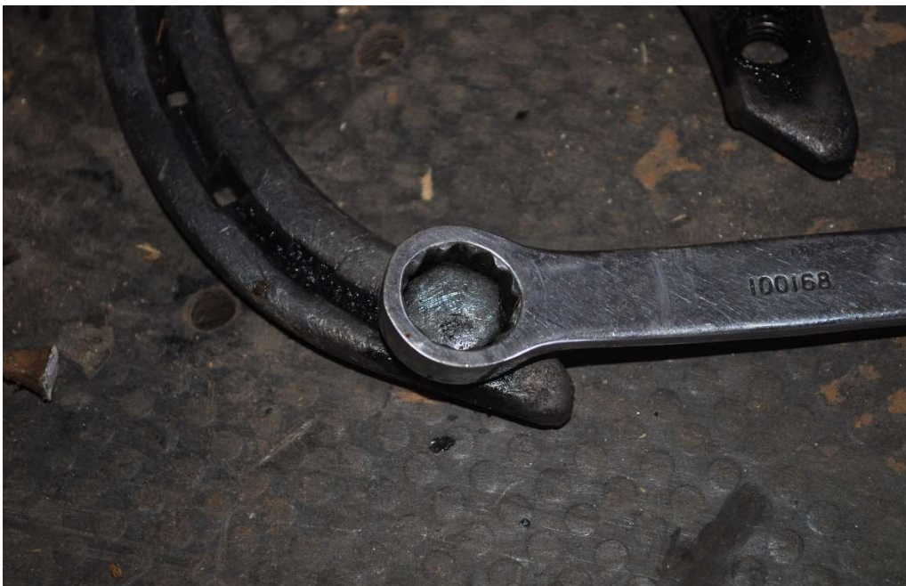
Figura 44. Colocando ramplón con la ayuda de una llave
