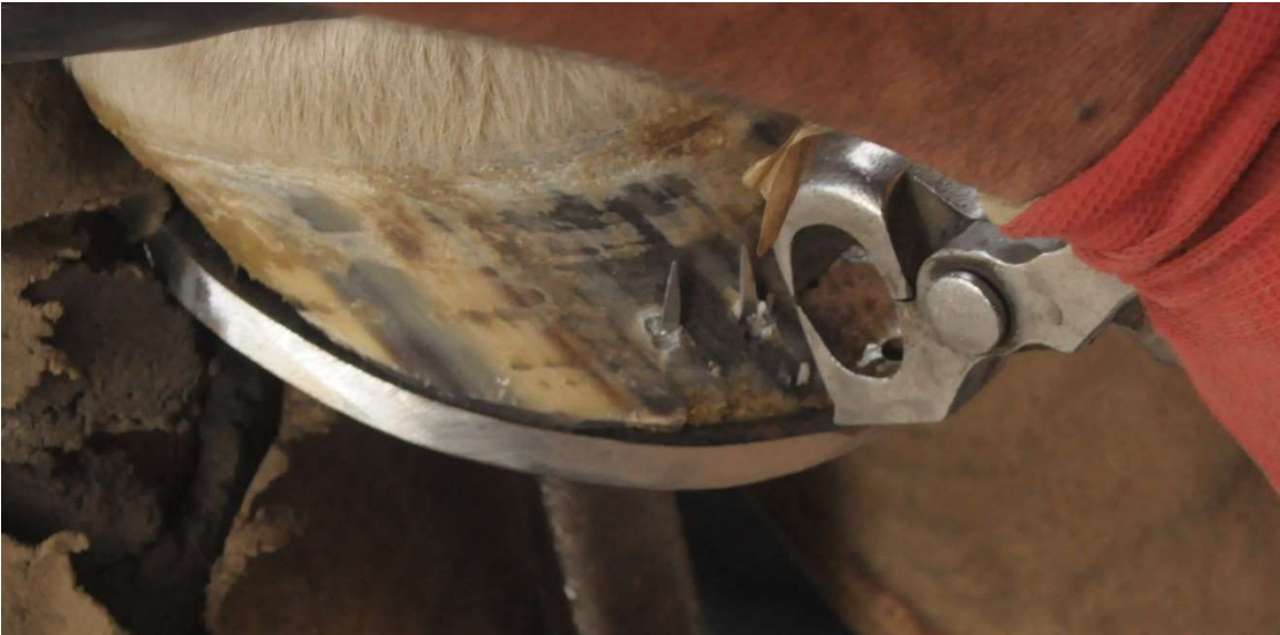
Figura 69. Cortando clavo con las tenazas en forma horizontal.
