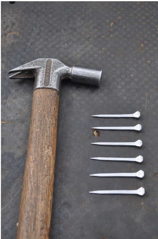
Figura 45. Martillo de clavar y clavos de herraje
