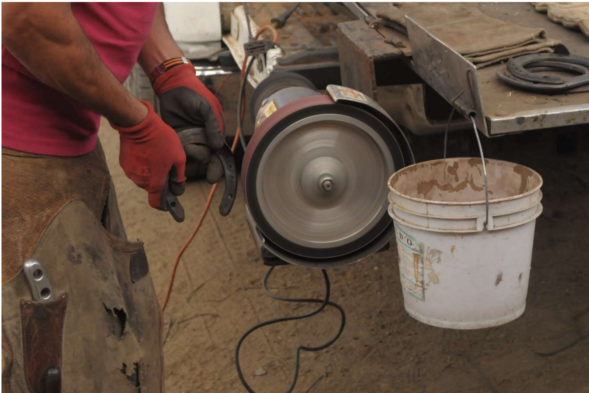
Figura 38. Biselando una herradura en un esmeril de banco
