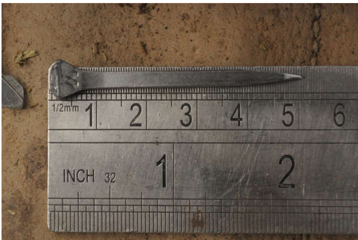
Figura 18. Clavo adecuado para equitación
