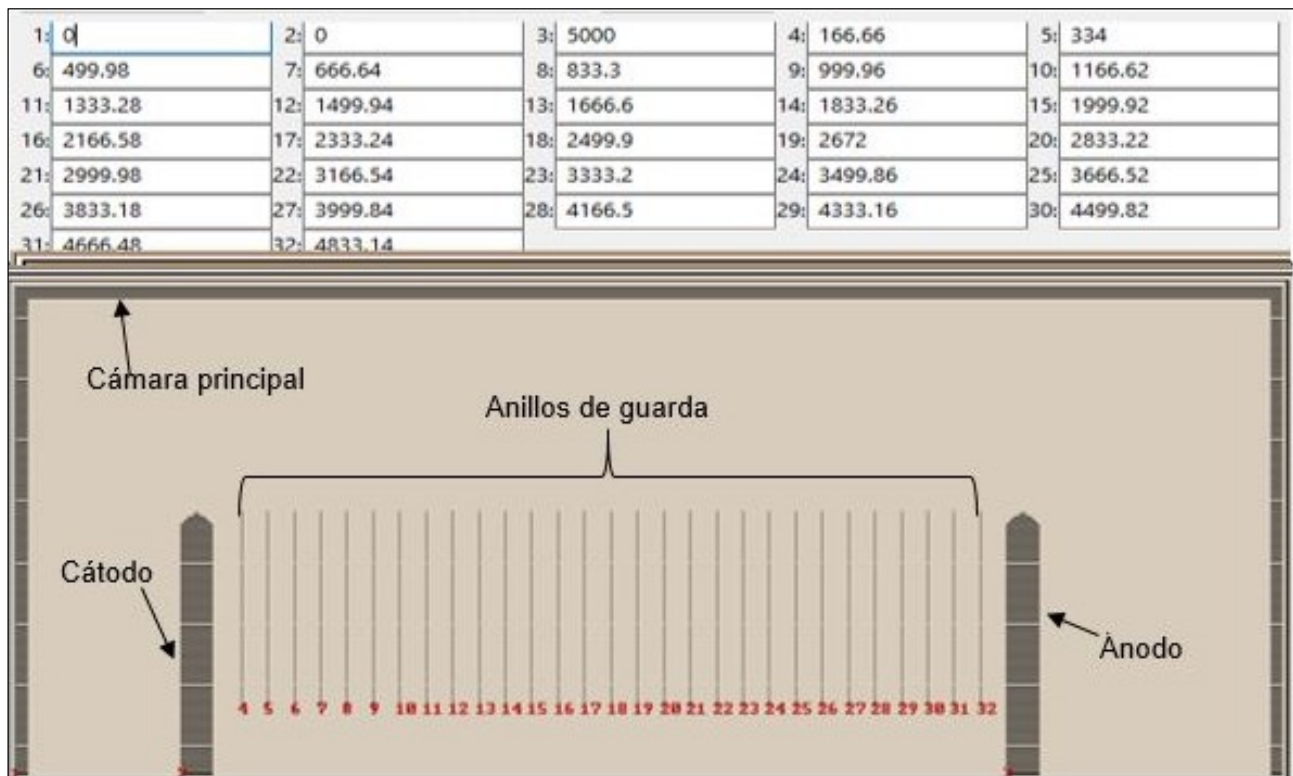
Figura 16. Configuración con sistemas de 29 anillos de guarda de espesor 1.32 mm
