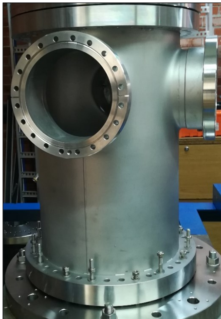
Figura 21. Cámara de acero inoxidable.
