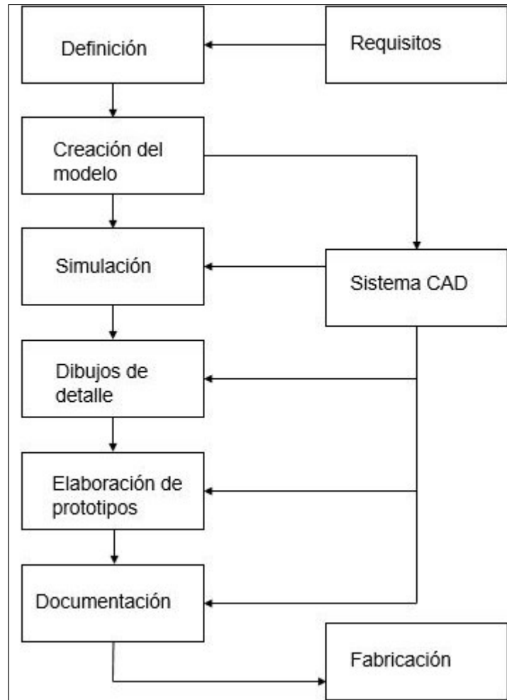
Figura 9. Proceso de diseño empleando la herramienta CAD.
