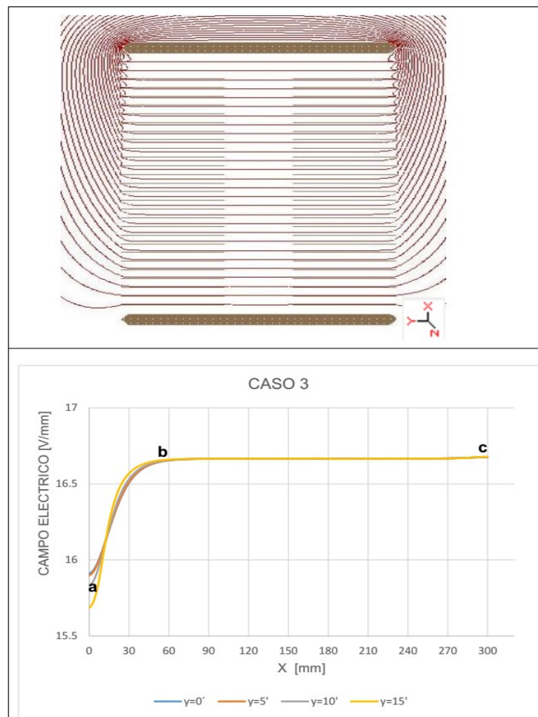
Figura 17. Distribución de líneas de campo eléctrico a detalle cercano a los electrodos con separación de 300 mm entre electrodos de 200 mm de diámetro a 5000 V. y variación de campo eléctrico en el intervalo de 0 a 15 mm de radio.
