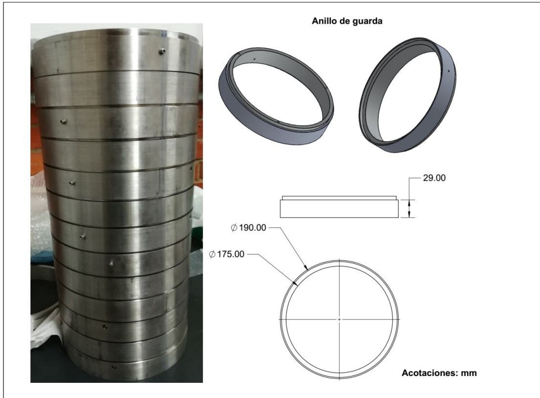
Figura 22. Anillos de guarda, vistas en CAD
