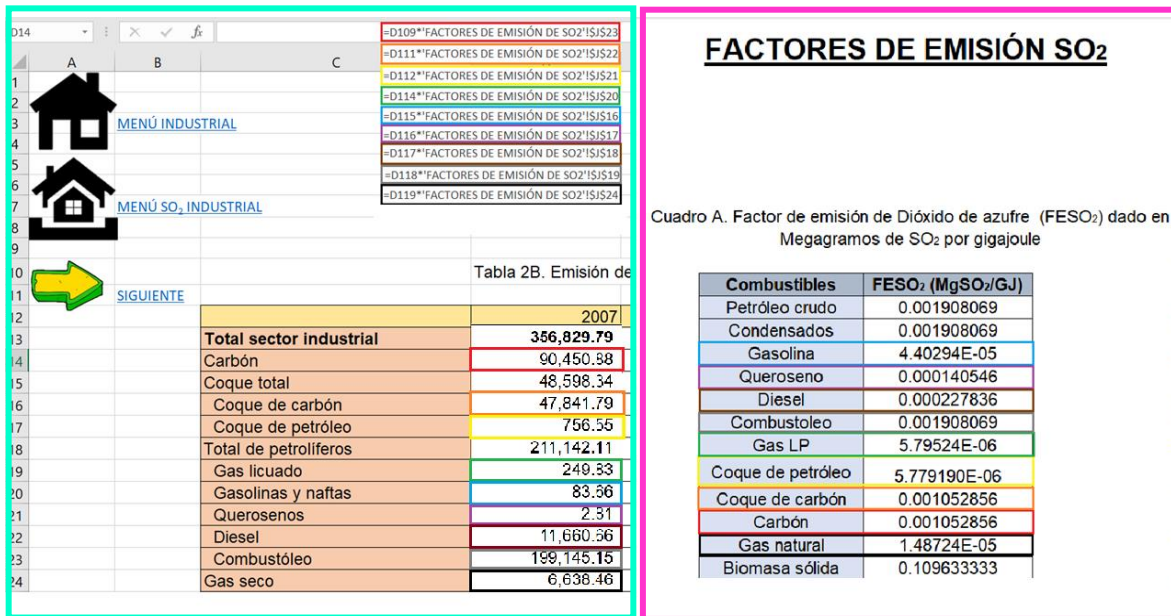
Figura 4.18. Proceso aplicado para la obtención de valores específicos de emisión. Delimitado en color, turquesa: vista general de las fórmulas y valores de emisiones de SO 2 para cada combustible en el año 2007, magenta: factores de emisión de SO 2 presentados en el "Cuadro A" dentro de la hoja de cálculo; rojo, anaranjado, amarillo, verde, azul, morado, marrón, gris, negro y rosa: factores de emisión, fórmula y resultado respectivamente para cada combustible utilizado en el sector industrial.
