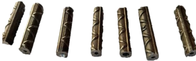
Figura 3.12 Piezas de varilla de acero de 3/8"
