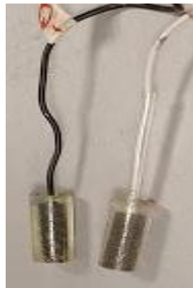
Figura 3.13 Varillas de acero de 3/8" encapsuladas.
