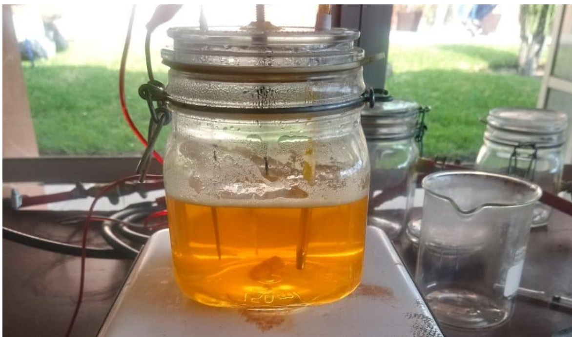
Figura 12. Tonalidad de la solución al finalizar el tratamiento de exposición al plasma en el tratamiento con agitación.
