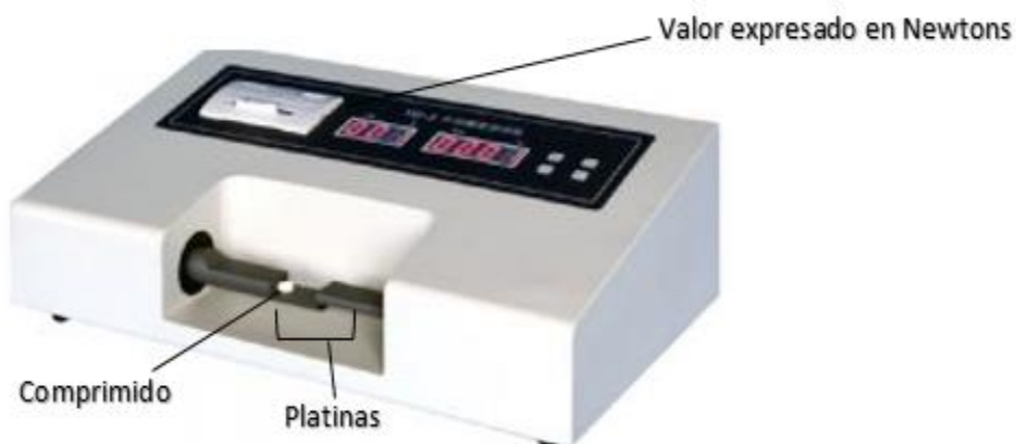
Figura 20. Ejemplo de un durómetro digital que cumple con las especificaciones que marca la USP. Imagen tomada de (Modelo Y2 - Durometro Proconsa, 2020)
