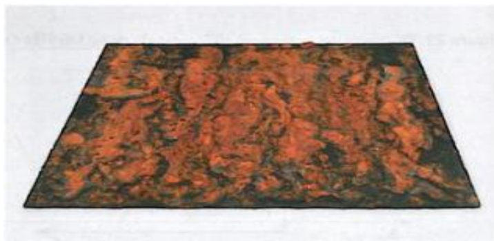
Figura 2.6 Corrosión uniforme en una placa de cobre.
