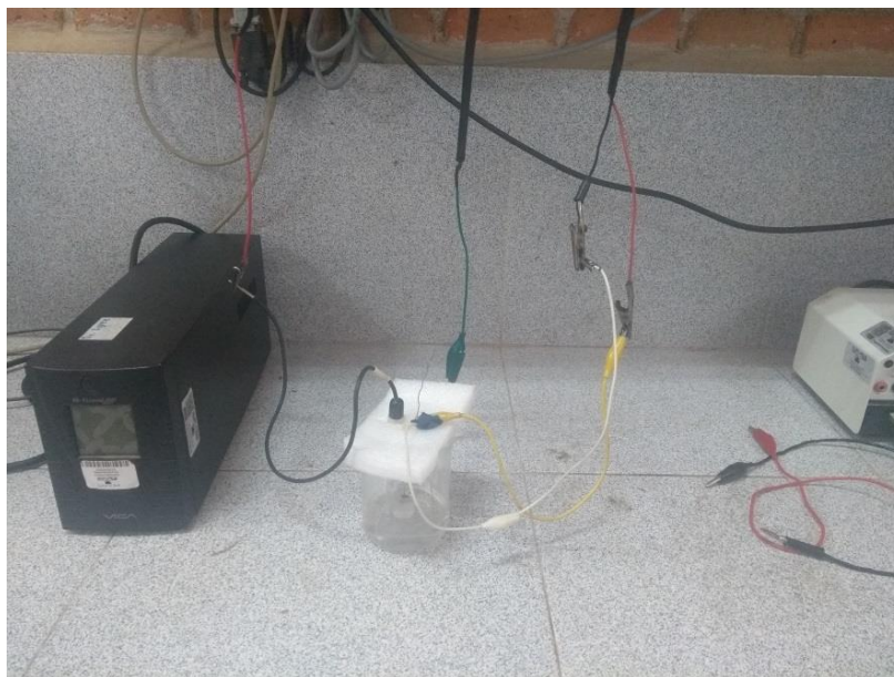
Figura 3.3 Celda electroquímica conectada al instrumento.
