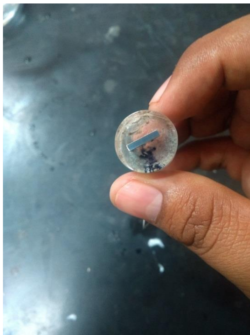
Figura 3.1 Muestra de aluminio embebida en resina epóxica.
