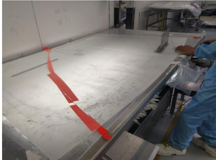
Ilustración 4. PVB en Mesa de Soldadura.
