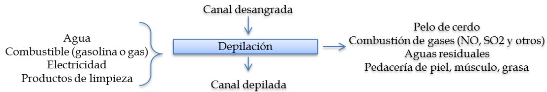
Figura 5.5. Diagrama de flujo de los insumos y los residuos generados en la depilación de la canal de cerdo. Fuente: Signorini et al. , 2006.
