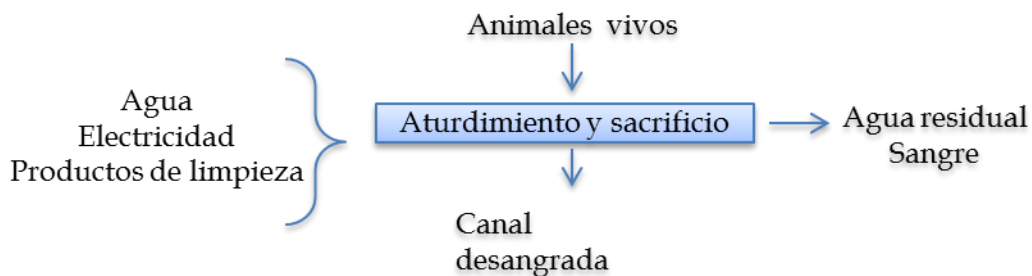
Figura 5.4. Diagrama de flujo de los insumos y los residuos generados durante la recepción y manejo del ganado. Fuente: Signorini et al. , 2006.
