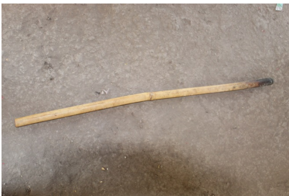
Figura 64. Soplador para fuego elaborado con bambú
