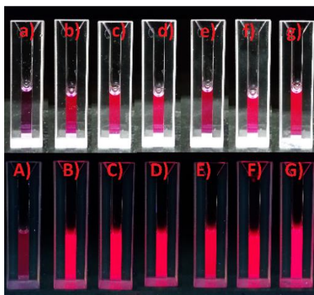
Ilustración 31 R-np-CN dispersas en: a) y A) Agua, b) y B) Metanol, c) y C) Etanol, d) y D) Isopropanol, e) y E) Pentano, f) y F) Acetona, g) y G) DMF, dónde a), b), c), d), e) f) y g) Están en expuestas a luz visible y A), B), C), D), E) F) y G) están expuestas a luz UV ( \lambda = 364 \text{ nm} ).
