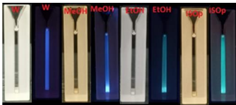
Ilustración 24 np-CNPEG dispersas en diferentes solventes expuestas a luz UV ( \lambda=365 nm) del lado izquierdo de cada solvente y luz visible del lado derecho respectivamente en cada solvente
