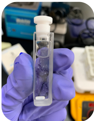
Figura 32. Celda de cuarzo con precipitado observado en punto de saturación de TDF, por método de solvent shift.
