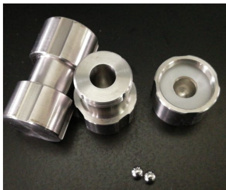
Figura 29. Contenedores de acero inoxidable de Molino Restch ® de capacidad de 100 mg.
