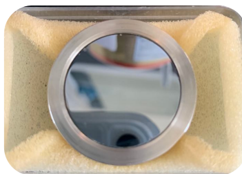
Figura 30. Portamuestra con acabado de fondo bajo utilizado para DRXP.
