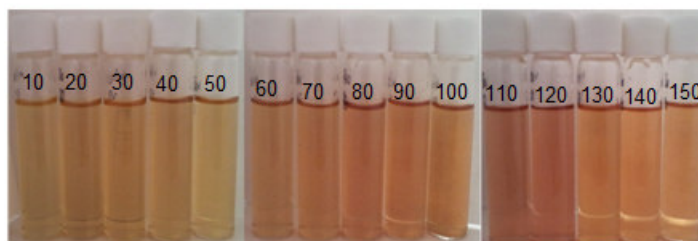
Figura 4.25. Serie de soluciones de la doble dilución 1/10 mL MeOH - 2/10 mL MeOH del DTC-Sn- n Bu, indicando cambios en la coloración.
