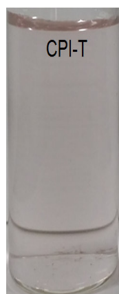
Figura 4.80. Imagen de la solución resultante de la relación 5/5 de Nt's de Ag y Np's de PI.
