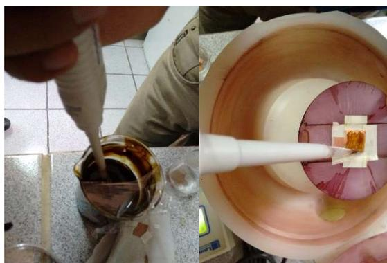
*Figura 3.5 Imágenes de depósito por spin coating*
