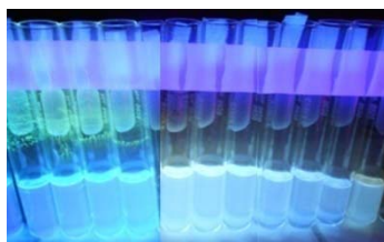
Figura 8. Hidrocarburos aromáticos revelados con luz UV
