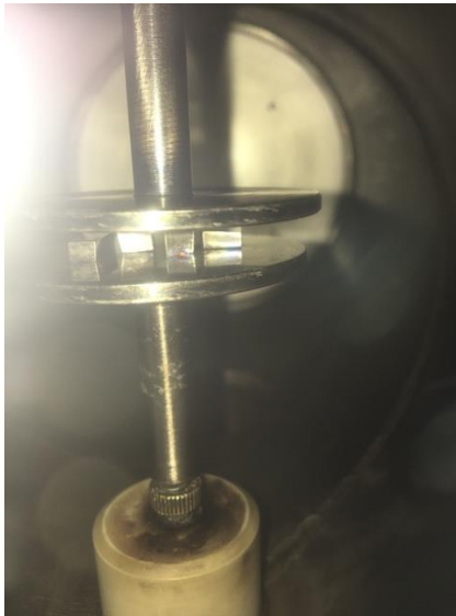
Figura 12. Vista de electrodos sin descarga.
