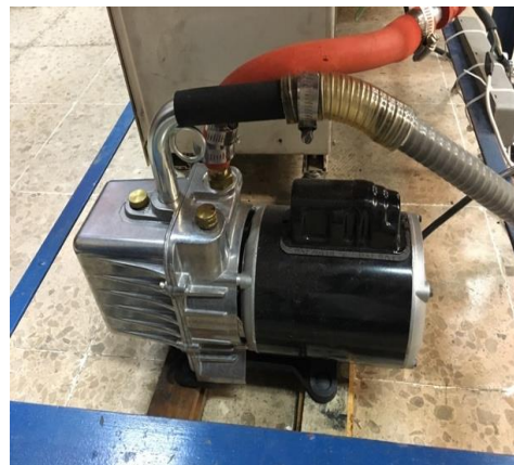
Bomba mecánica para realizar vacío.
